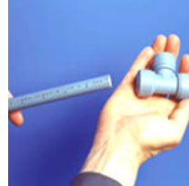
Insertar el tubo en la pieza. Girar un poco y presionar hasta el fondo. Para finalizar, pegar un fuerte tirón del tubo.
