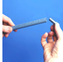
Comprobar que no hay rebabas y colocar el casquillo en el tubo.
