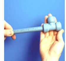
Insertar el tubo en la pieza. Girar un poco y presionar hasta el fondo. Para finalizar, pegar un fuerte tirón del tubo.
