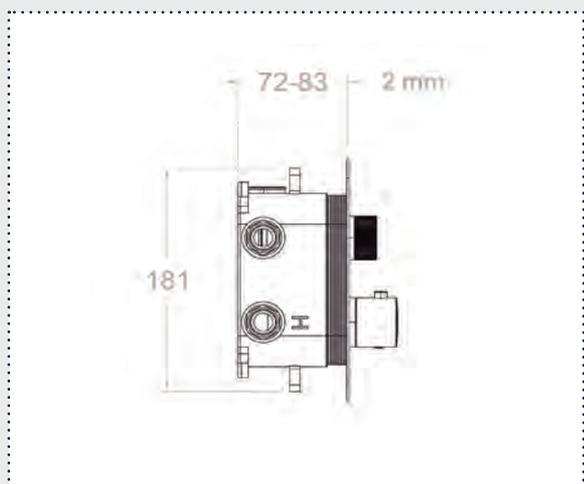
Box completamente estanco y evita filtraciones de agua en el interior de la pared. Puede ser instalada en cualquier tipo de pared, por ejemplo, pladur o standard.
